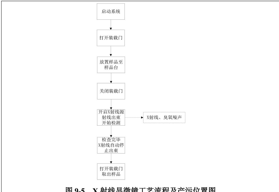
**图 9-5 X 射线显微镜工艺流程及产污位置图**
